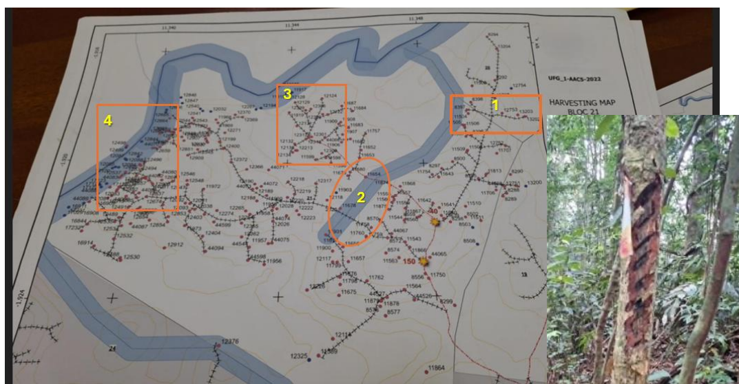
Figure 14 : Cartographie anonymisée représentant les arbres à abattre ainsi que les pistes de débardages planifiées (a) et Photo d'un piquet marqué à 8 reprises représentant ainsi 8 arbres dans cette direction (b).
