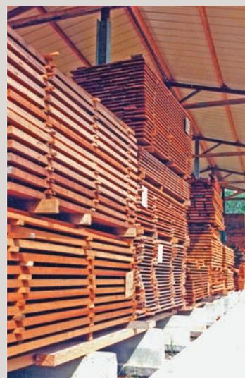
voriser la ventilation et réduire l'influence de l'humidité au sol. La surélévation doit être au minimum de 40 cm.
