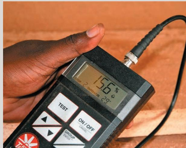
▲ Photo 62 : Contrôle de l'humidité du bois © E. Groutel
