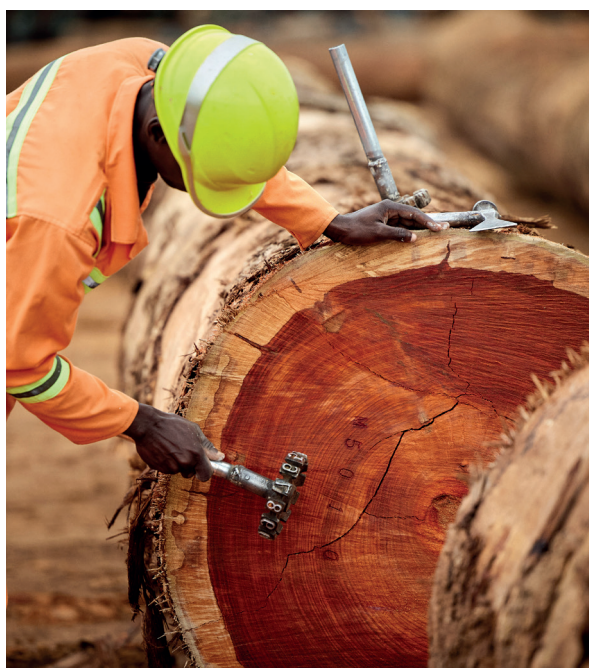
Marquage d'une grume de Padouk (© ATIBT)
