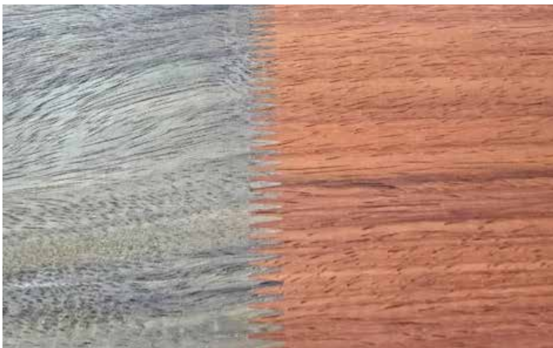
Détail d'un aboutage sur une lame de terrasse (Tali et Padouk) Congolaise Industrielle des Bois (CIB), Pokola (Rép. du Congo) © Laurent Duffard (CIB)
