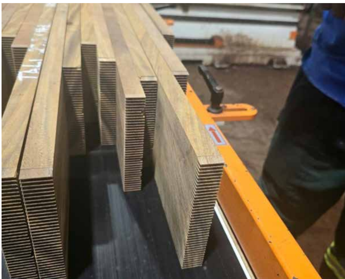
Pièces de Tali en cours d'aboutage pour production de lames de terrasse Congolaise Industrielle des Bois (CIB), Pokola (Rép. du Congo) © Laurent Duffard (CIB)
