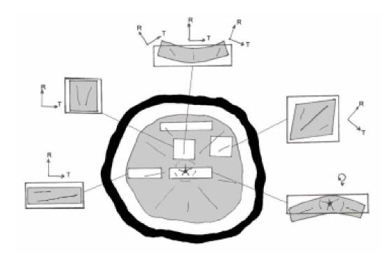
La justification de la déformation par calcul est simple : Dans l'exemple d'un carrelet de section carrée en Niangon de 12 cm de diagonale, débité sur faux quartier. S'il passe de 28 à 12 % d'humidité.
