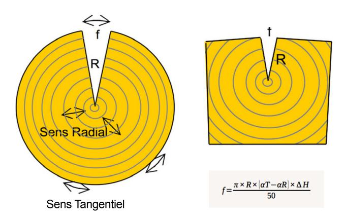
Le positionnement des fentes sur les bois ronds est difficilement prévisible. Elles se produisent sur la distance la plus courte entre le cœur et le bord, ou dans les zones les plus fragiles (à proximité des nœuds par exemple).
