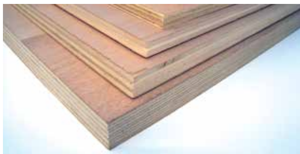
▲ Photo 30 : Différentes compositions de contreplaqué © M. Vernay
